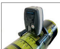
Abbildung 6.1-3 Messen von Punkten in 3D (in der Druck- maschine) mit Sleaf
