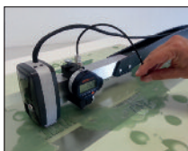
Abbildung 6.1-5 Messen und Protokollieren von Relieftiefen und Plattenstärken mit Relix
