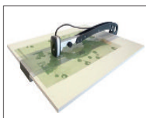
Abbildung 6.1-4 Messen großer Platten mit Flex 3 XXL
